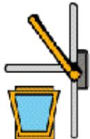
Für den Fall, daß die Fenster aufgrund der Lage, durch Wind oder Sog in der Kippstellung zuschlagen bzw. in der Drehstellung auf- oder zufallen, stehen spezielle Zubehörteile zur Verfügung.
